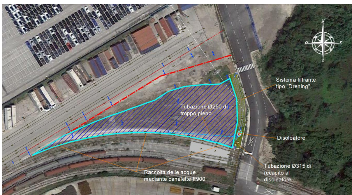
Delimitazione di bacino rappresentante la falda sud e schema di funzionamento idraulico
