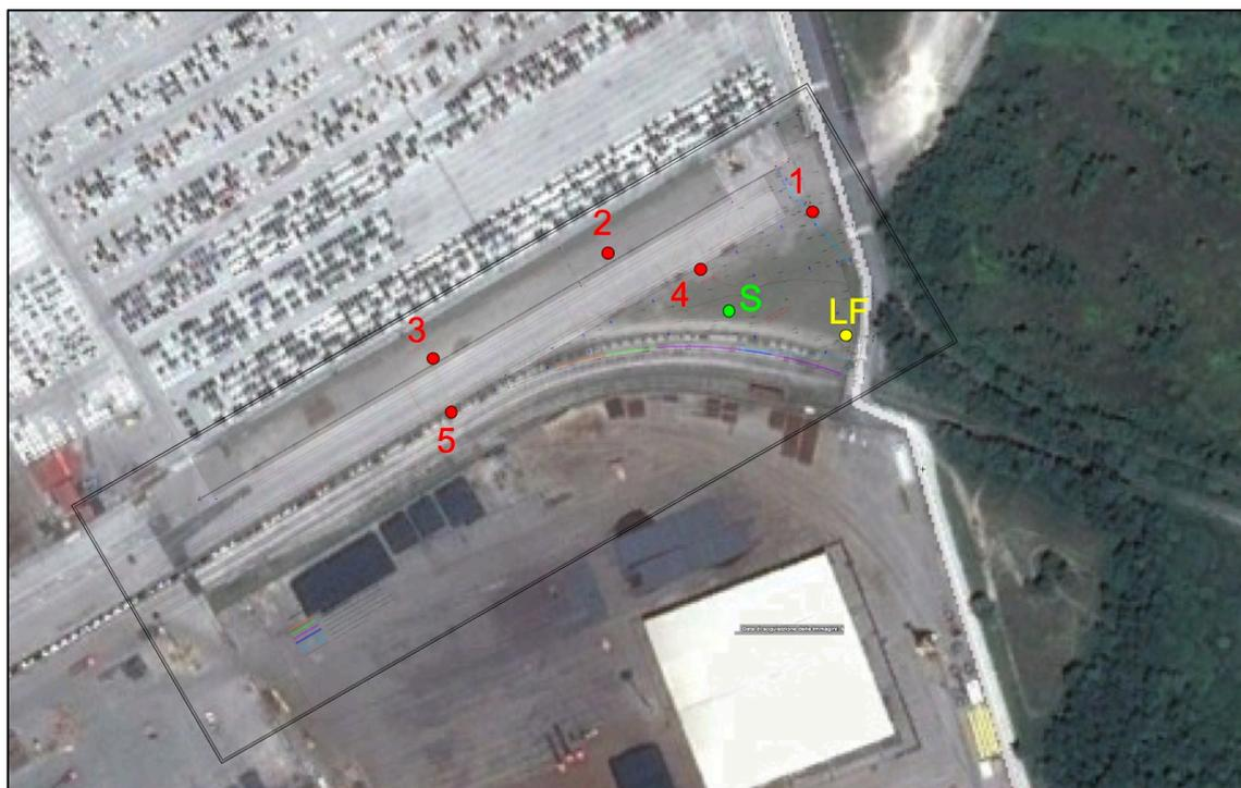
Figura 8 - Localizzazione delle indagini geognostiche. In rosso, prove di carico su piastra PLT; S, sondaggio meccanico; LS, prova di permeabilità in foro
