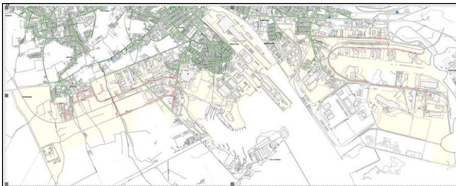
Fig.16 In rosso è segnata la rete di distribuzione gas (metri 10.418,65 di proprietà consortile) gestita da AcegasApsAmga
