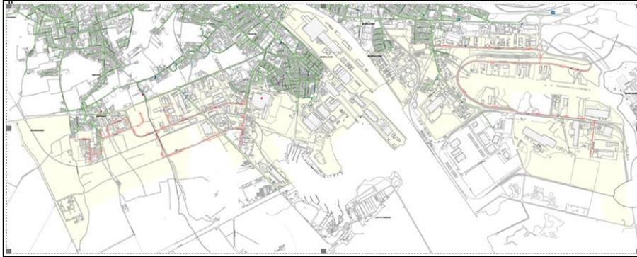
Fig.12 In rosso è segnata la rete di distribuzione gas (metri 10.418,65 di proprietà consortile) gestita da AcegasApsAmga
